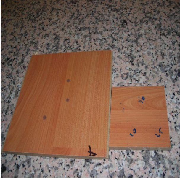
Şekil 2.10. Büyük bilye test düzeneği ve levha örnekleri
