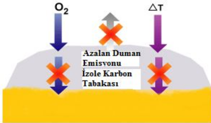
Şekil 1.13. Amonyum polifosfatın yanma üzerine etkisi (URL-2011h)
