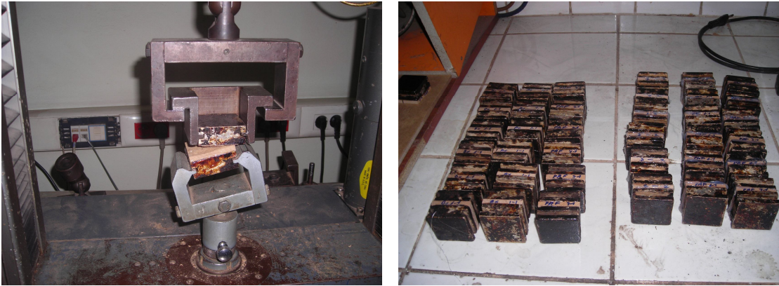
Şekil 2.3. Yüzeye dik çekme test makinesi ve örnekleri
