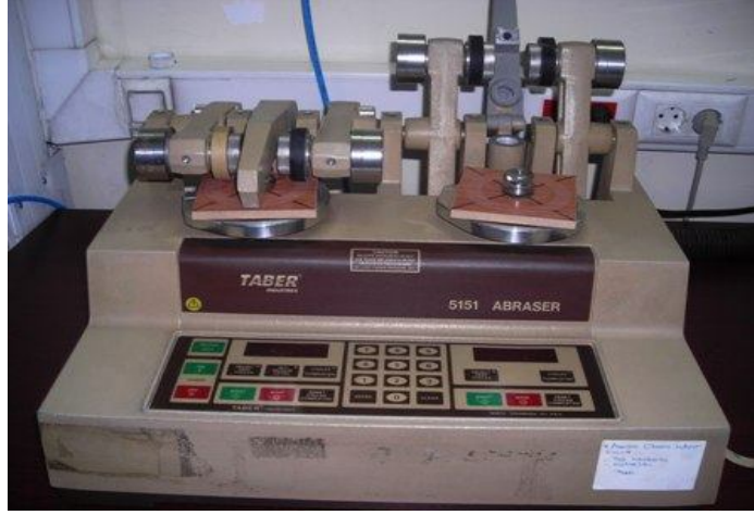
Şekil 2.5. Aşınma direnci test cihazı
