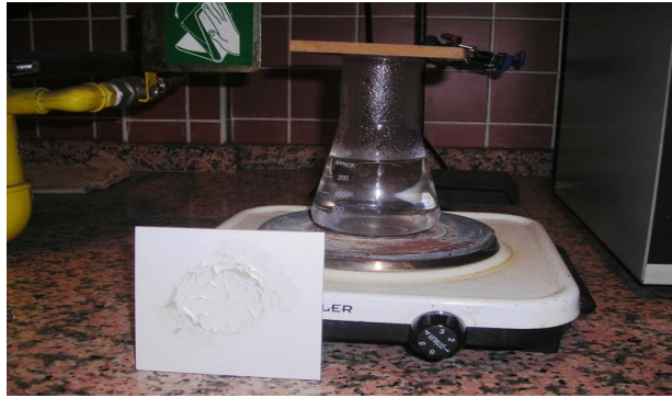
Şekil 2.11. Su buharı test düzeneği
