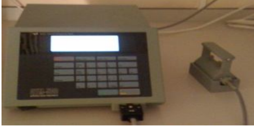
Şekil 2.2. Quick Thermal Conductivity Meter (QTM 500 Kyoto) marka ısı iletim katsayısı ölçüm cihazı
