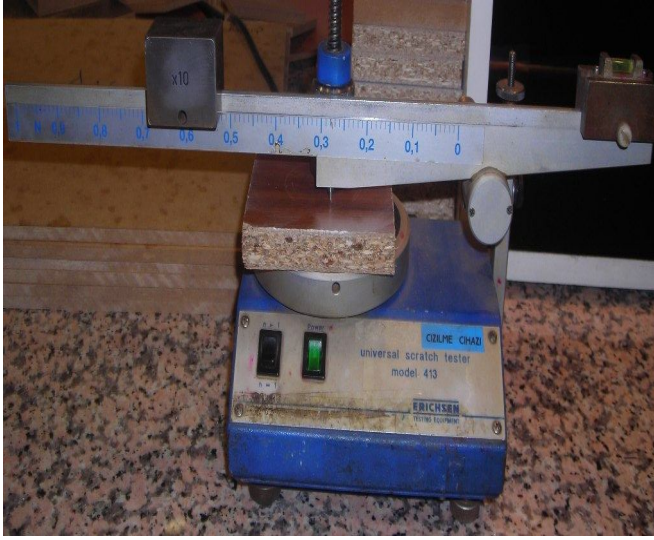
Şekil 2.7. Çizilme direnci test makinesi ve gözlem kabini
