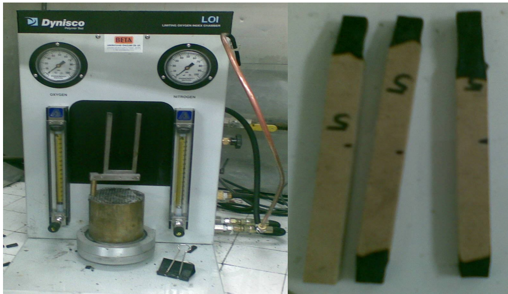
Şekil 2.17. Limit Oksijen indeksi cihazı
