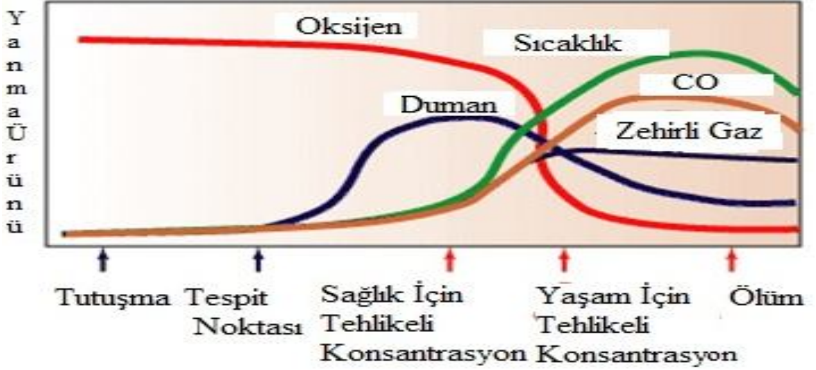
Şekil 2.15. Yanma sırasında açığa çıkan gazlar ve limit değerleri
