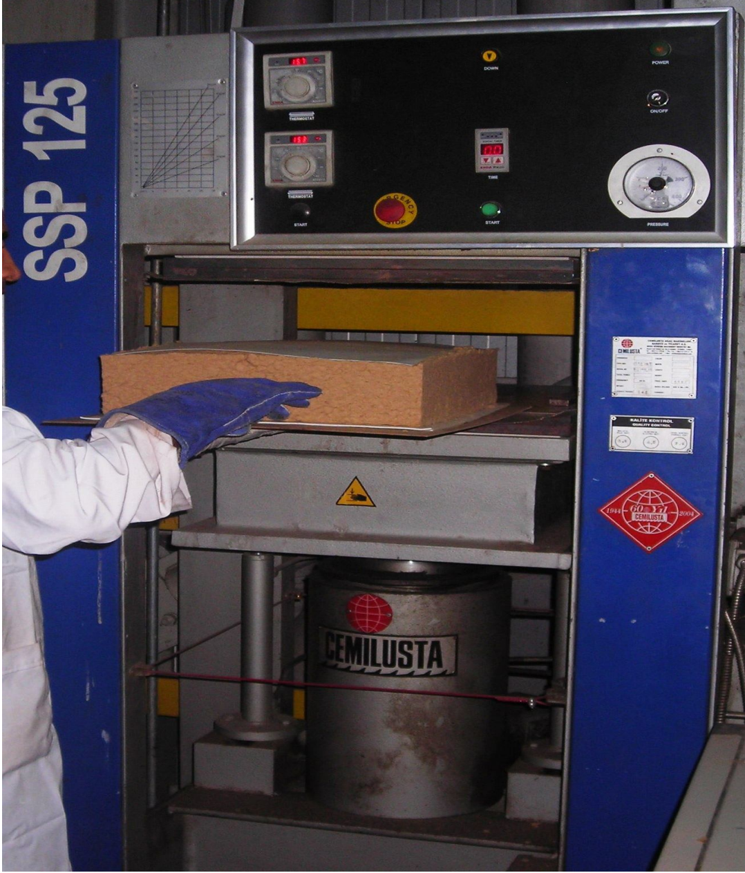
Şekil 2.1. Cemil Usta SSP 125 Laboratuvar tipi pres makinesi
